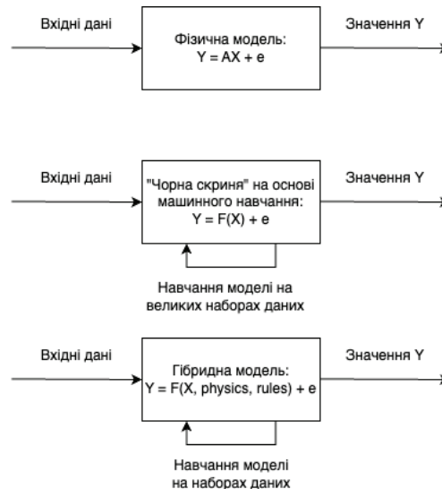
Рис. 1. Фізична модель на основі системи рівнянь і правил та альтернативи з використанням машинного навчання: «чорна скриня» та гібридна модель
