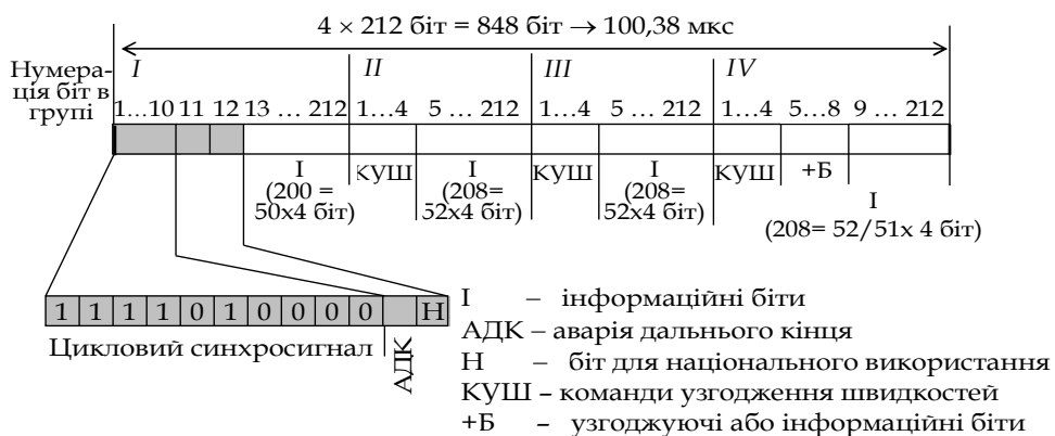
Рис. 5. Параметри циклу вторинного ЦП з додатнім вирівнюванням (G.742)
