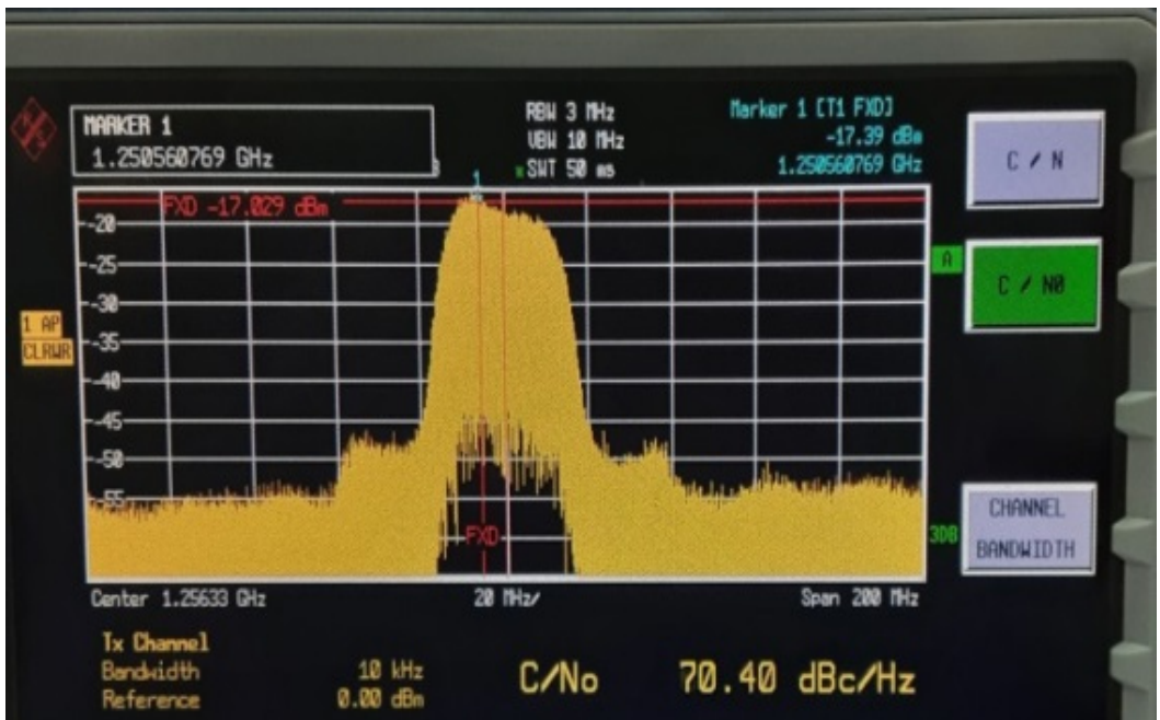
Рис. 19. Спектр сигнала для визначення відношення потужності сигналу до спектральної густини потужності шуму
